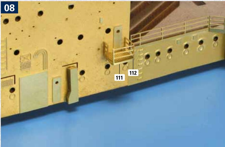
Biegen Sie die kleine Reling 112 entlang der beiden kleinen Falze rechtwinklig. Kleben Sie die Reling anschließend an der Grätting 111 fest, wie abgebildet.
