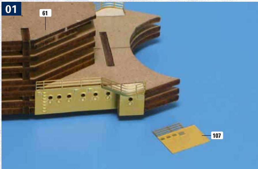
Legen Sie die vordere Aufbaustruktur auf Ihre Arbeitsplatte, ausgerichtet wie abgebildet: Die Arbeiten beginnen im steuerbord-vorderen Bereich. Legen Sie die Wand 107 vor die Aufbaustruktur.
