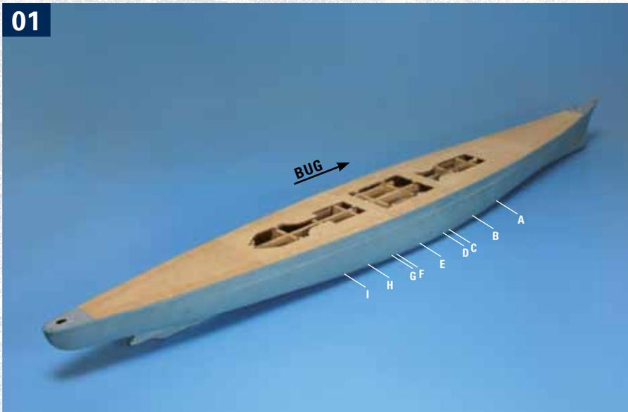
Stellen Sie den Rumpf auf Ihre Arbeitsfläche. Mit diesen Bauschritten werden auf der rechten Seite des Rumpfs die Löcher zum Einsetzen des Schlingerkiels gebohrt. Die Buchstaben A–I zeigen die Position der neun Löcher im Mittschiffsbereich in der Übersicht. Die exakte Position entnehmen Sie den Angaben auf den Fotos der Schritte 02 und 03.
