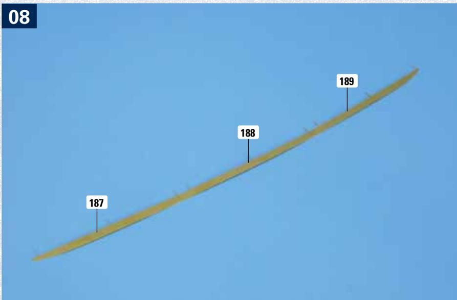
Setzen Sie das hintere Ende von Teil 189 probeweise auf dem vorderen Ende von Teil 188 auf. Nehmen Sie die Teile wieder auseinander und versehen Sie deren Kontaktflächen mit Sekundenkleber. Kleben Sie die Enden der beiden Teile 188 und 189 exakt bündig aufeinander fest, wie abgebildet.
