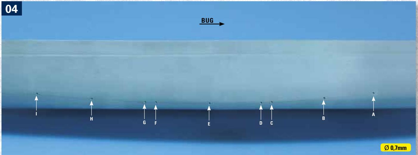
Mit einem Handbohrer mit 0,7-mm-Durchmesser bohren Sie die neun Löcher am Rumpf, wie es das Foto zeigt.
