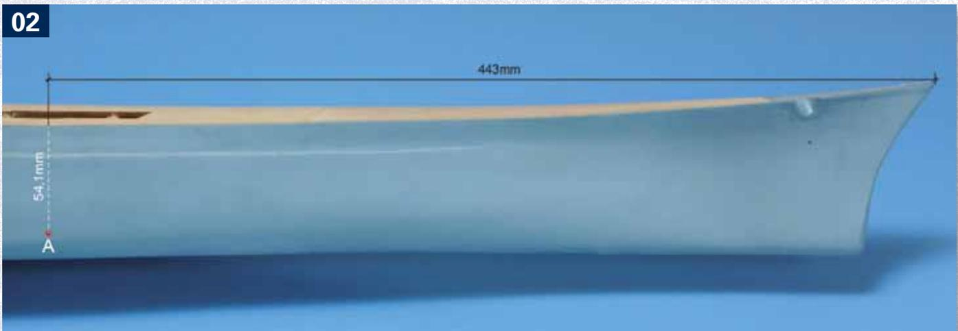
Das Foto zeigt, wo genau Sie die Markierung für das vorderste Loch (A) am Rumpf anbringen müssen. Zunächst messen Sie 443 mm von der Bugspitze ab, anschließend messen Sie vom Oberdeck in Richtung Schiffsboden eine Strecke von 54,1 mm ab. Dort markieren Sie den Rumpf mit einem Bleistift.
