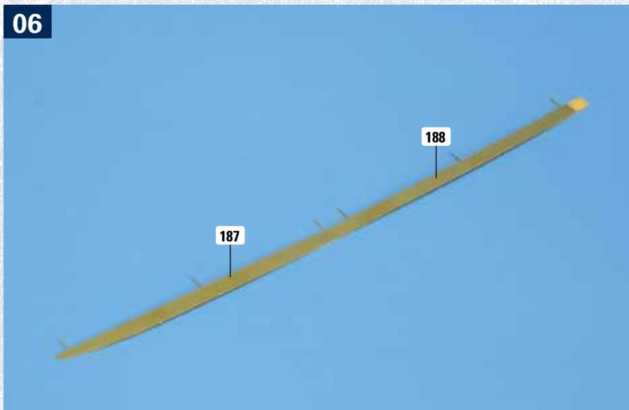
Positionieren Sie die dünnen Enden der beiden Teile 187 und 188 testweise exakt bündig aufeinander. Nehmen Sie die Teile wieder auseinander und versehen Sie deren Kontaktflächen mit Sekundenkleber. Kleben Sie die Enden der beiden Teile 187 und 188 exakt bündig aufeinander fest, wie abgebildet.
