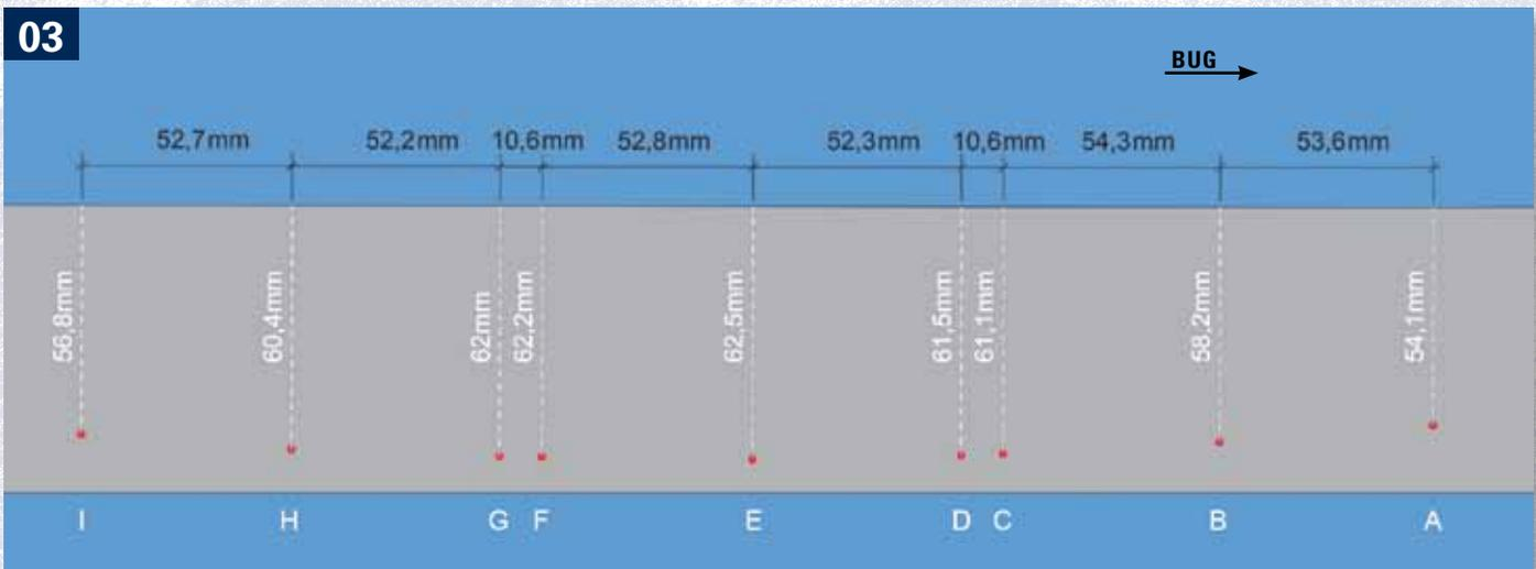
Das Foto zeigt, wo, ausgehend von der Markierung A, die folgenden acht Markierungen B, C, D, E, F, G, H und I am Rumpf angebracht werden. Messen Sie jeweils zunächst die angegebene Distanz auf dem Oberdeck ab, bevor Sie die vertikale Distanz am Rumpf abmessen.
