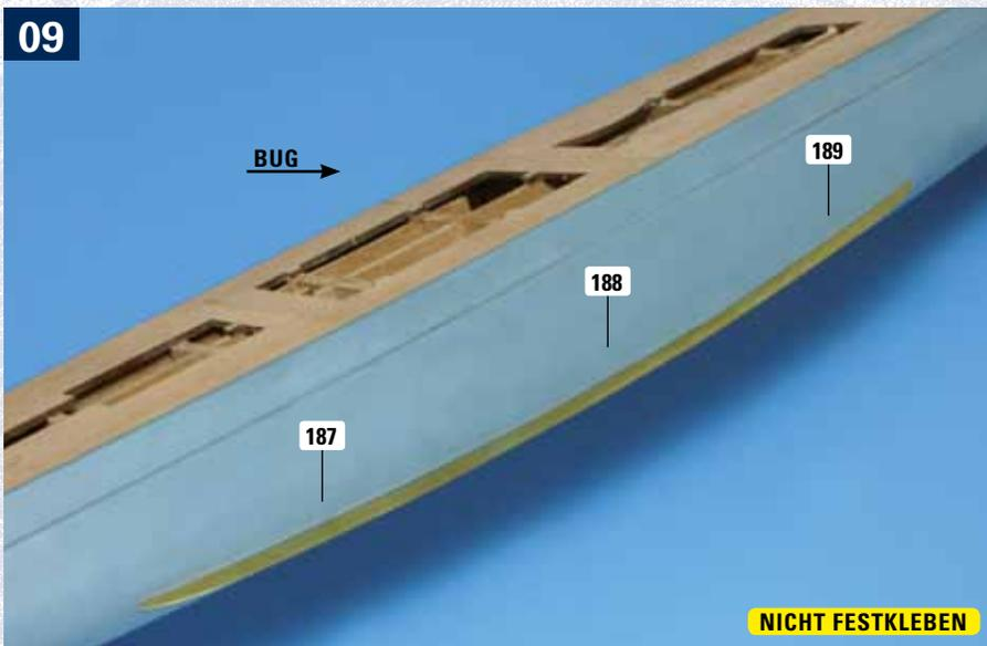
Setzen Sie die Zapfen des Schlingerkiels in die neun Löcher am Rumpf ein. Abschnitt 189 befindet sich vorne, Abschnitt 187 achtern. Mit der übernächsten Anleitung werden die oberen Verstärkungsteile am Steuerbord-Schlingerkiel angebracht.
